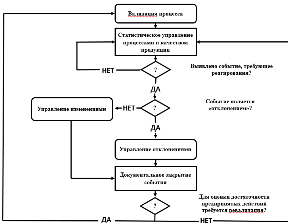
Взаимосвязь элементов системы качества при производстве продукции
